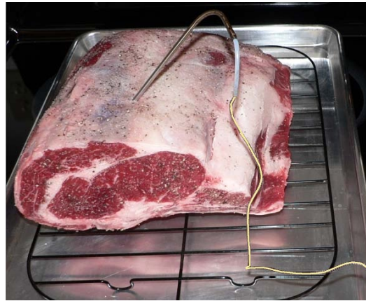
图 3: 刺入式温度探头测量食品内部的温度
